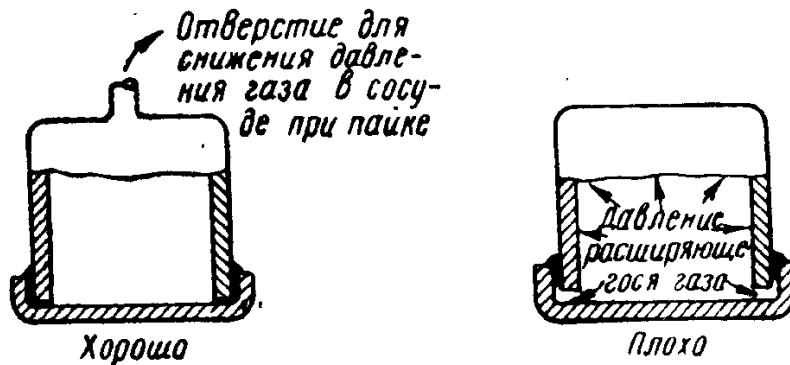
Фиг. 27. Вентиляция контейнеров в процессе пайки.
