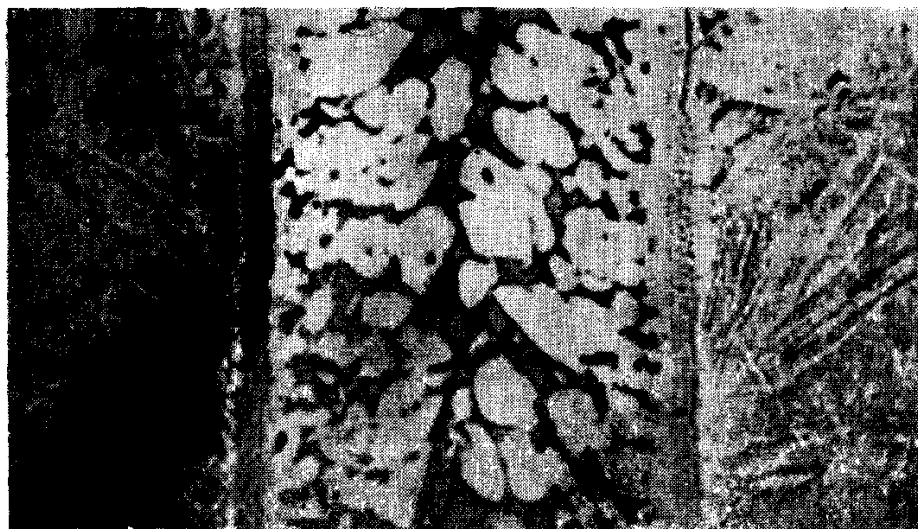
Фиг. 82. Соединение из титана, паянное припоем BAg-1a (травление 20% \text{HNO}_3 + 20% \text{HF} + 60% глицерина). \times 500 .
